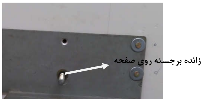
شکل 6- صفحه مخصوص کنترل صفر شاخص نصب شده روی دیوار
