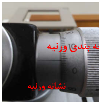
شکل 31- قرائت عدد ورنیه معادل 4 میکرومتر
