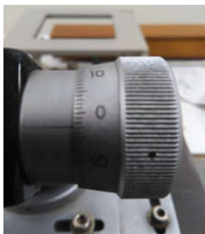
شکل 37- قرائت عدد ورنیه معادل 97 میکرومتر
