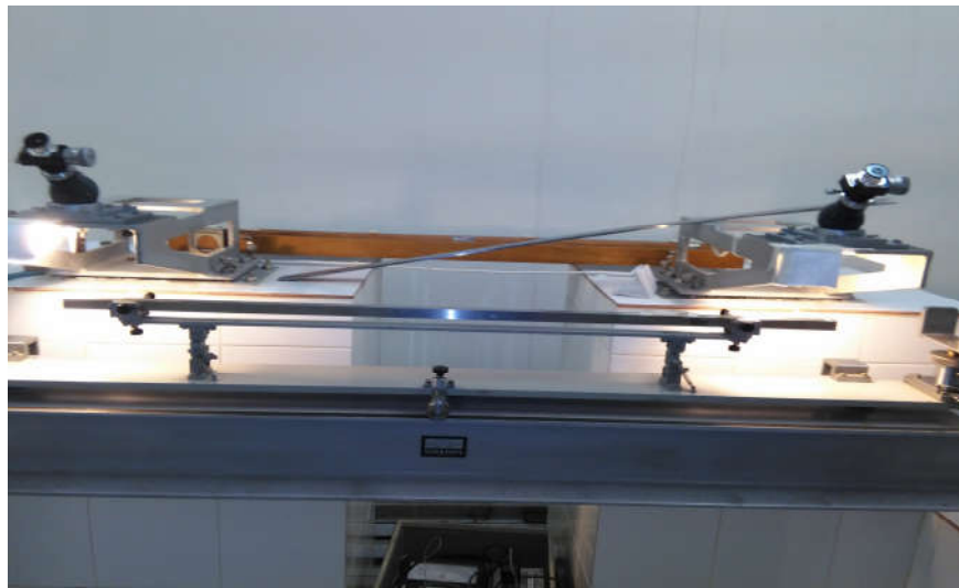
شکل 8- متر استاندارد در زیر دستگاه کالیبراسیون
