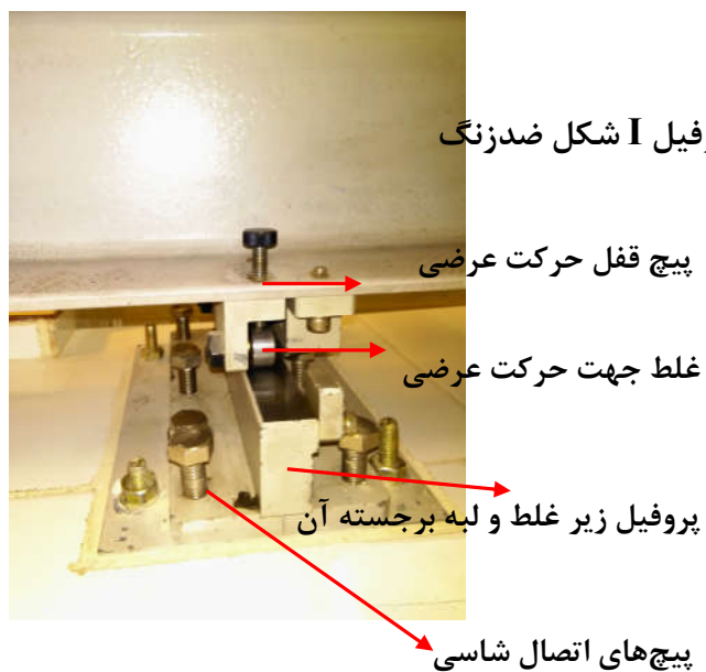
شکل 11- صفحه و پیچ‌های اتصالی شاسی زیرین به ستونک سمت راستی دستگاه، غلتک و پیچ قفل حرکت عرضی شاسی
