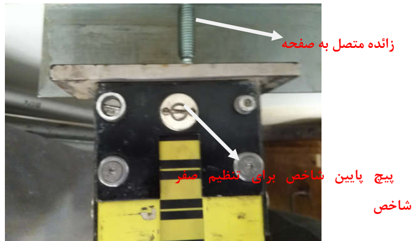
شکل 3- نمایی از پیچ تنظیم صفر
