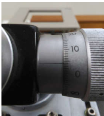
شکل 35- قرائت عدد ورنیه معادل 4 میکرومتر
