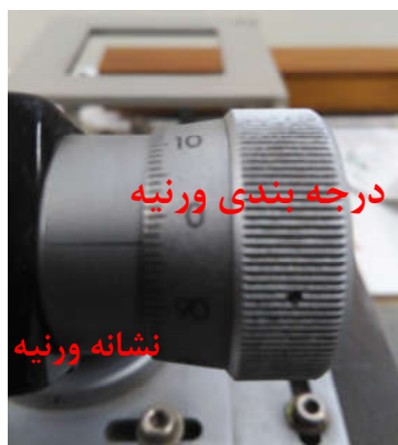
شکل 30- قرائت عدد ورنیه معادل 97 میکرومتر
