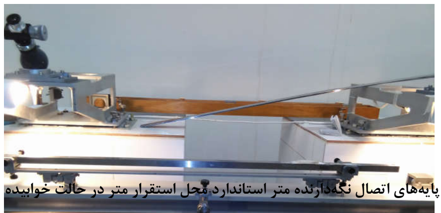
شکل 19- استقرار متر استاندارد بین گیره‌ها
